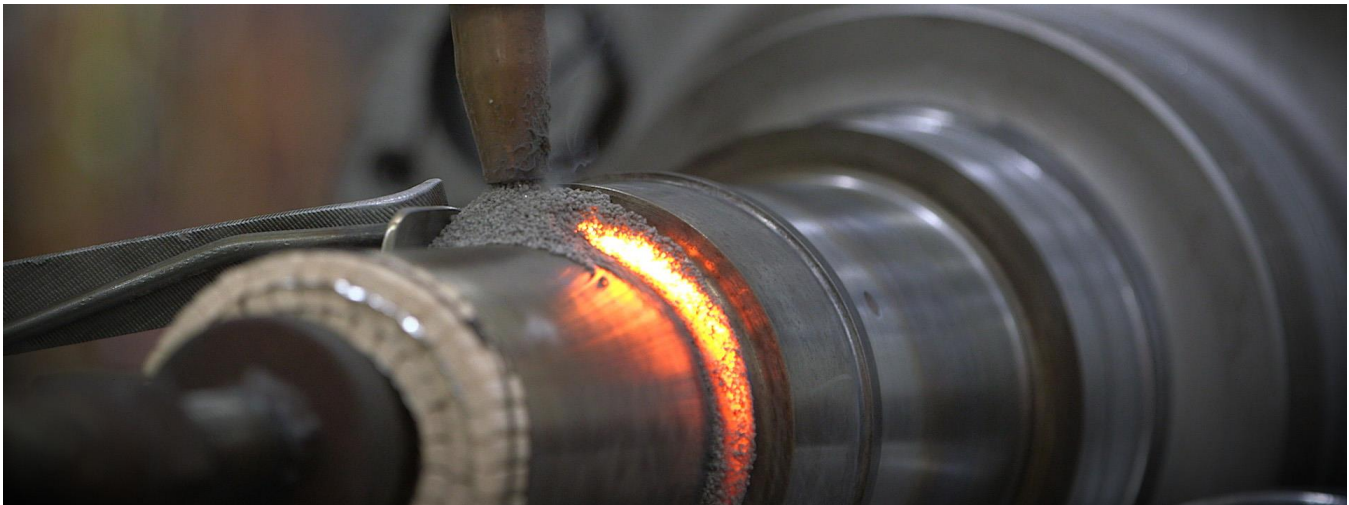
شکل 30 روتور با شفت ( محور ) جوشکاری شده
